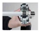
Pressvorgang mit einer TH-Kontur: Das Presswerkzeug ansetzen und den Kunststoffring der Edelstahlhülse in die Führung der Pressbacke einlegen. Danach den Pressvorgang (je nach Maschinentyp) auslösen. Der Pressvorgang ist beendet, wenn der vollständige Pressbackenschluss erreicht ist. Es müssen 2 breite Rillen auf der Edelstahlhülse gleichmäßig umlaufend sichtbar sein.
